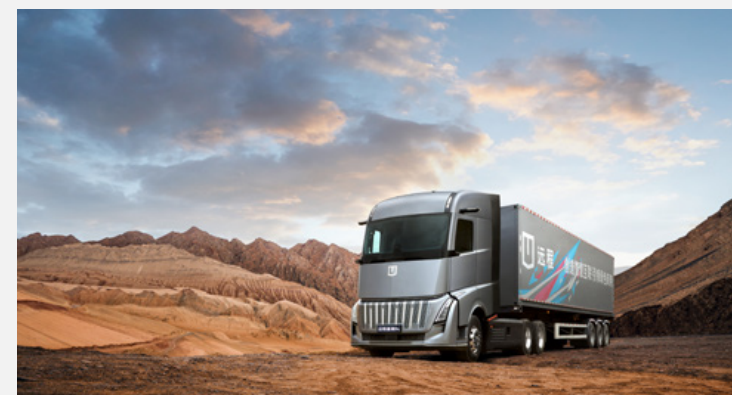
远程星瀚重卡在吐鲁番火焰山试验场完成超高温测试
